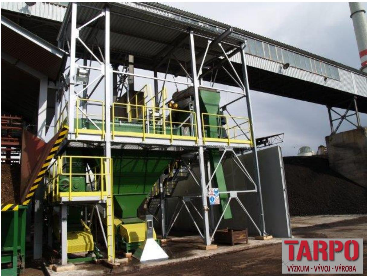
Sušárna kalů a digestátů, výrobce TARPO s.r.o.
