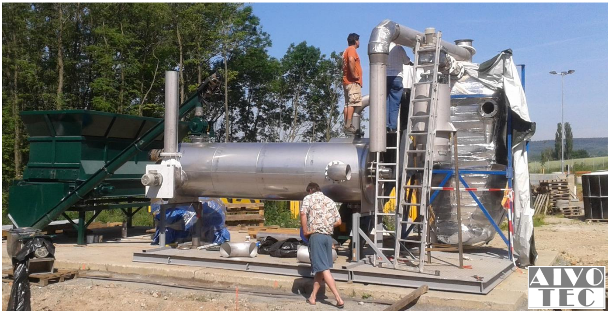
Zařízení pro karbonizaci biomasy na biouhel, kapacita 0,5 t/h, dodavatel AIVOTEK s.r.o.
