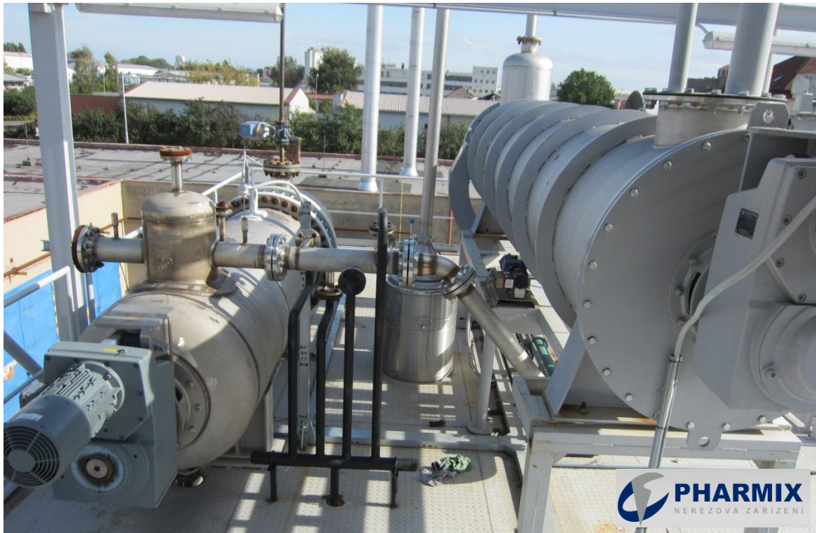
Zařízení pro parní expanzi, kapacita 2 t/h, výrobce PHARMIX s.r.o.
